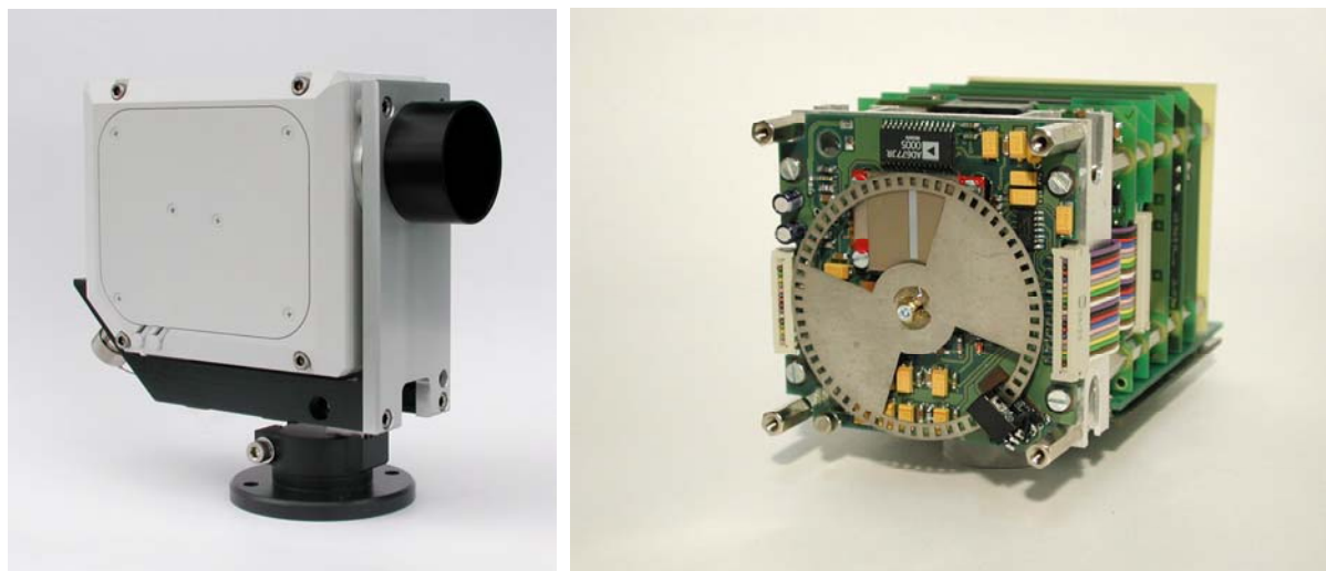
Bild 3: Ungekühlte Infrarot-Linienkamera PYROLINE (oben: Gesamtansicht, unten: Sensormodul)
